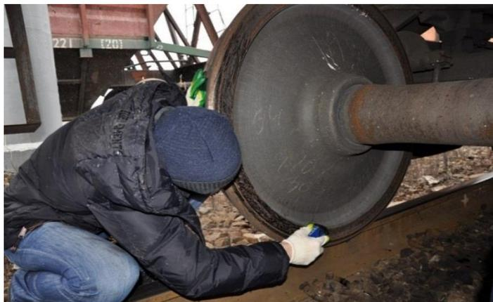
Рис. 1 – ручное модифицирование колес вагонов
