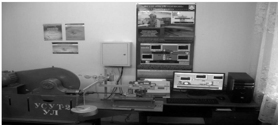
Рис.4 Экспресс-трибометр УСУТ-2-УЛ
