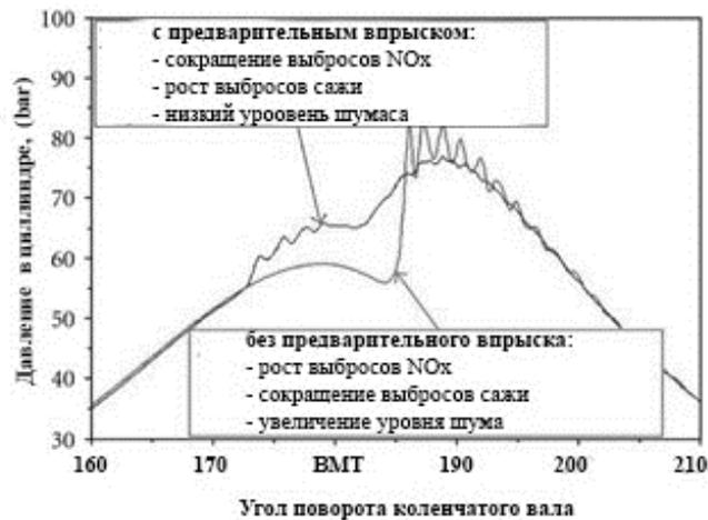
Рис. 1: Зависимость давления в цилиндре с превпрыском и без предварительного впрыска от угла опережения впрыска.
